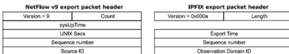
Figura 9 – Cabeçalho IPFIX X Cabeçalho Netflow (KREJCI, 2009)
