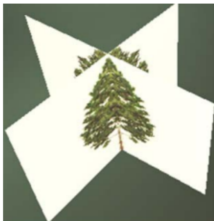
Figura 2.1 Representação de árvores 3D a partir de painéis cruzados. (Adaptado de Falcão et al. (2006)).
