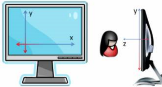
Figura 3.7 Relação entre os eixos cartesianos tridimensionais e um dispositivo de saída (Adaptado de Luque e Silva (2010)).
